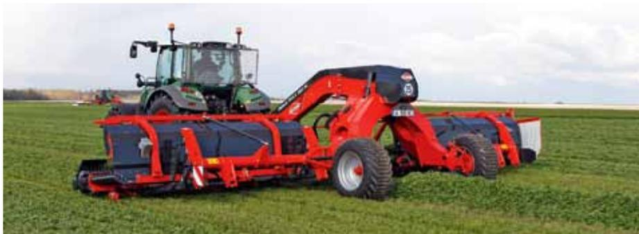
Auf der SIMA 2019 hat Kuhn den Bandschwader Merge Maxx 950 ausgestellt. Das Modell bietet zwei Bänder, eine Arbeitsbreite von 9,5 Meter (Mittelschwad) und 8,8 Meter (Seitenschwad) an. Der Listenpreis liege in der Größenordnung eines Vier-Kreisel-schwaders, berichtete Verkaufsleiter Rainer Krug. Neben dem Merge Maxx führt Kuhn ein breites Kreisel-schwader-Sortiment.
