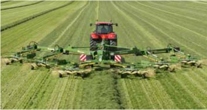
Der Swadro 2000 von Krone ist mit sechs Kreislern und einer variablen Arbeitsbreite von zehn bis 19 Meter ein Riese unter den Mittelschwadern. Schwadleistungen von bis zu 20 Hektar pro Stunde seien kein Problem. Zudem würde sich die Gesamtlänge der Schwade um rund 30 Prozent reduzieren.
