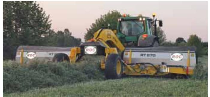
fekt sorgt für eine saubere und gleichmäßige Aufnahme des Mähgutes.“ Durch den werkzeuglos verstellbaren Streuwinkel kann unter anderem die Intensität der Aufbereitung verändert werden, um den kürzer werdenden Erntefenstern gerecht zu werden.
