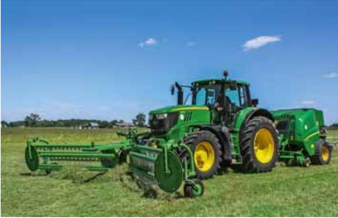
Der Kammschwader Twist 600 von SaMASZ wird meist in der Front angebaut, was einen gleichzeitigen Einsatz mit einer folgenden Erntemaschine – wie Pressen oder Ladewagen – ermöglicht.
