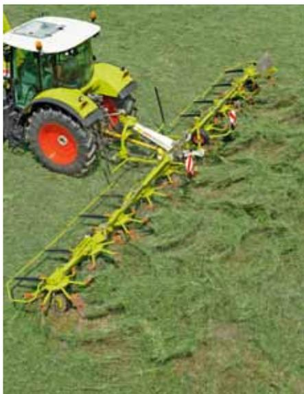
Mit dem tangential angeordneten Zinkenarm des Volto von Claas habe man den Gutfluss deutlich verbessern können, so Produktmanager Thilo Bruns. So sei der Aufnahmebereich um 30 Prozent größer und die tangentielle Anordnung verbessere die Breitverteilung.
