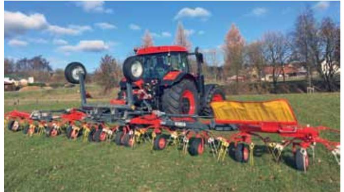
Für die Saison 2019 hat Rožmitál einen neuen zehnrоторigen Wender vorgestellt, den OZ-1110. Dieser ist mit einer Arbeitsbreite von elf Meter das größte Modell des Unternehmens. Für das kommende Jahr ist der zweirotorige Schwader SP-962H in der Pipeline, der eine Arbeitsbreite von 9,6 Metern ermöglichen soll.
