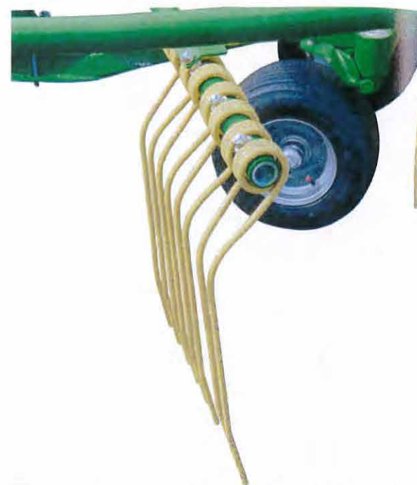
Particolare dei denti "Lift" a doppia inclinazione montati sul ranghinatore Swadro TS 680 Twin della Krone. Detail of the double-tilt "Lift" teeth mounted on the Krone's Swadro TS 680 Twin rake.
