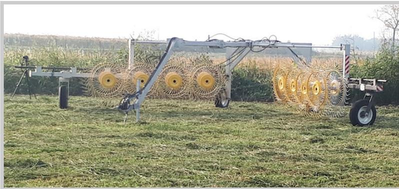
Prove che in campo che coinvolgono diversi tipi di macchinari – in particolare, il nuovo ranghinatore a doppia stella e il tradizionale rotante, il più diffuso al momento – messi a confronto per valutare l'impatto dei vari metodi di ranghinatura sulla qualità del foraggio ottenuto dopo la fase di andanatura.
