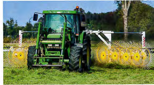
Die neue RA-Rake von Repposi soll durch ihre zweireihige Anordnung der Sterne verschmutzungsarmes Ernten ermöglichen.
