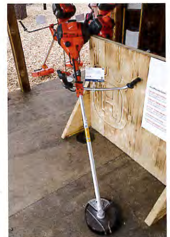
Husqvarna bietet mit dem 8,4 kg schweren 545 FXT einen neuen Forst-Freischneider an. Das Gerät wird serienmäßig mit dem Tragegurt Balance XT angeboten.
