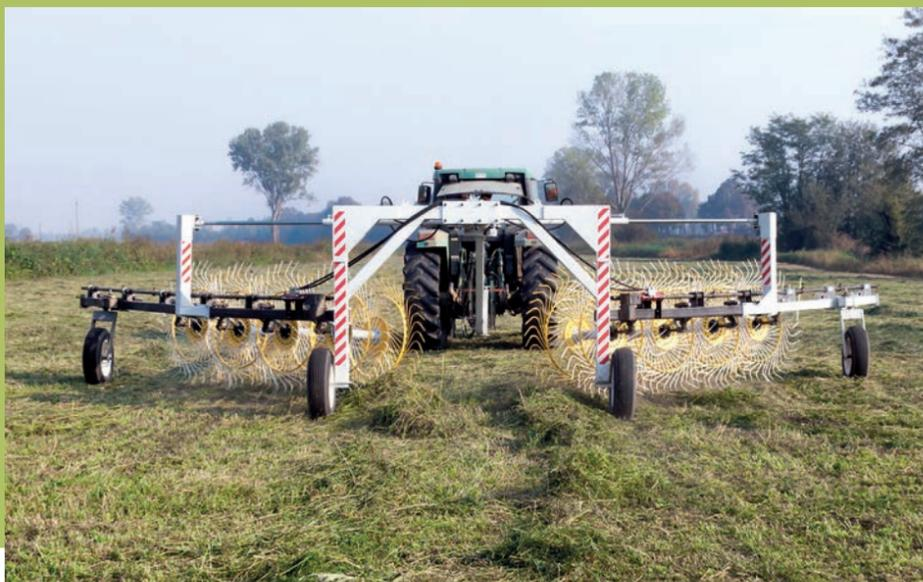
► RA-Rake presenta una configurazione ad andana centrale con due larghezze di lavoro tra 7 e 9 metri, come range iniziale, ma l'obiettivo del team ingegneristico di Casorate Primo è quello di proporre modelli fino a 14 metri e in grado di raggiungere la velocità di 20-25 km orari in pianura
